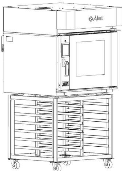
Рис. 4а Общий вид печи КЭП-5ПП на подставке ПК-12-6/4 с зонтом ЗВВ-5-6/4П
